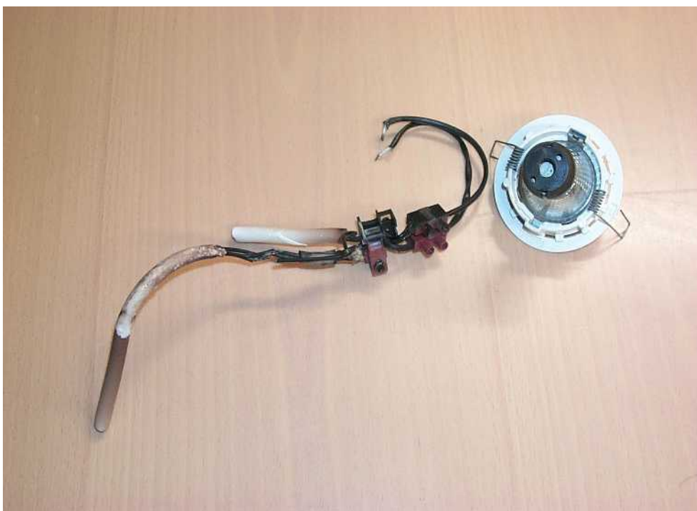
Figur 22 Bild på en halogenlampa som var inblandad i ett brandtillbud i Malmö.
